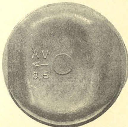
Bild 12 Zur Kolbenmontage: Die Kennzeichnung «AV» muß zur Lüfterseite (nach vorne) zeigen!
